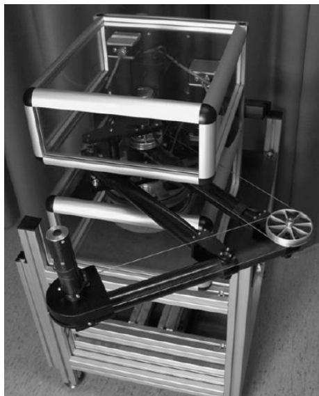
Figuur 2: Foto van een zogenaamde “horizontal two-joint manipulandum” robot om het leren van armbewegingen te onderzoeken (Foto uit het artikel van Howard, et al. , 2009).
